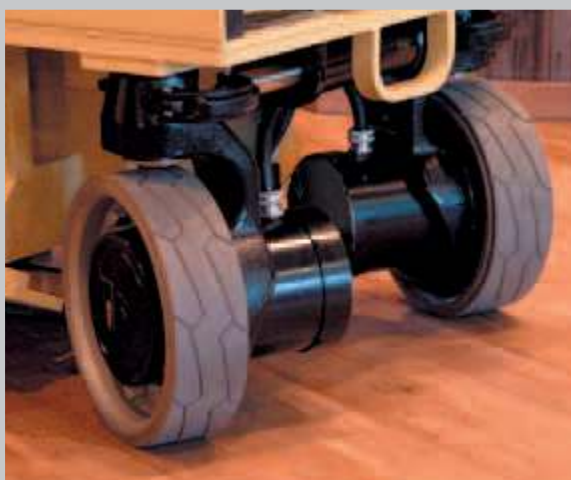
Tutti i modelli di piattaforme aeree a pantografo serie ES hanno la trasmissione elettrica diretta e una batteria a lunga durata
