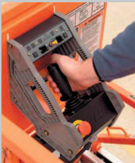
Comando completamente proporzionale delle funzioni di marcia e sollevamento
